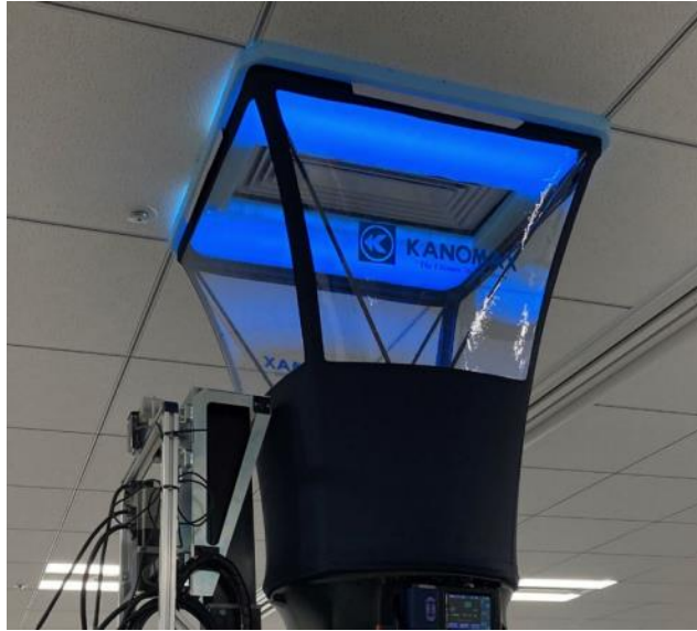
レタナー一体型制気口の風量測定の様子 (照明部分は吸い込み口を兼ねるため塞がれている)
