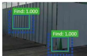
万能堀・フェンス・看板の倒れ検知
