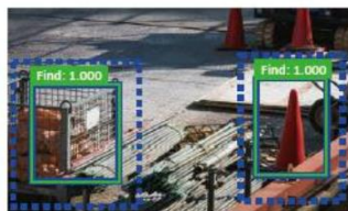
安全用具（コーン・バリケード等）の移動検知
