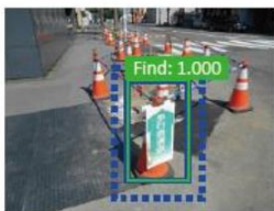
安全用具（コーン・バリケード等）の移動検知
