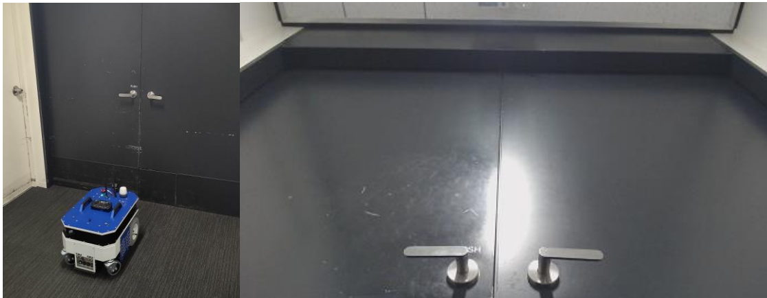
ロボットが点検対象のドアに正対して写真撮影している様子（左）と実際に撮影された写真（右）
