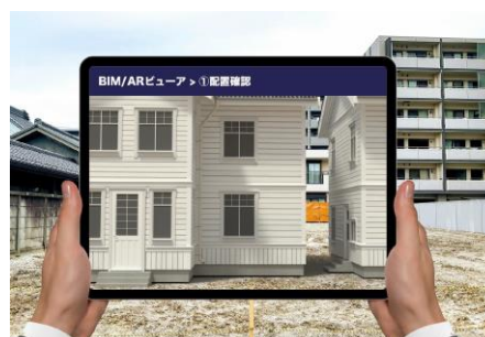
画面上で 3D 化された完成パースが正確な位置が表示されます。
