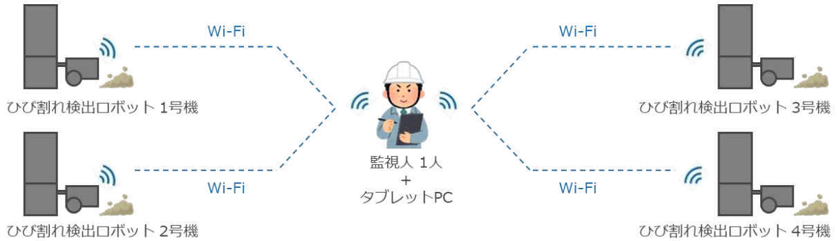
図1：モニタリングシステムの概要図
