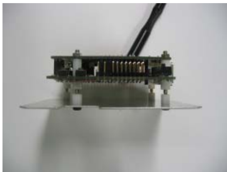
Fig.2.1 RM-board とアルミプレート取り付け
